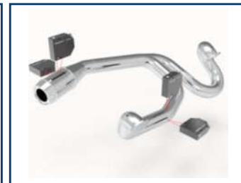
测量消声器的振动
